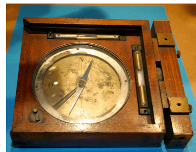
Boussole de mine. Vers 1900. Appareil utilisé par le géomètre pour établir les plans des réseaux de galeries. Cette boussole lui sert à orienter ses plans. Coll. Maison de la métallurgie et de l'industrie de Liège et conservé au Domaine touristique de Blegny-Mine. Musée du Puits Marie
