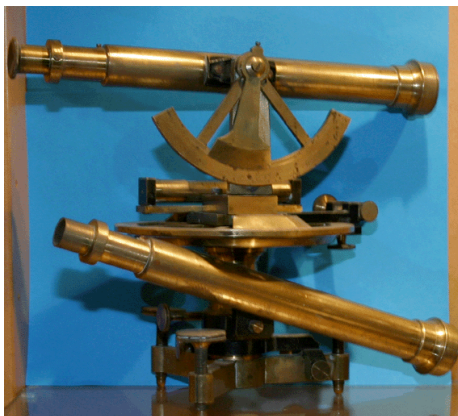
Théodolite. Vers 1900. Appareil utilisé par le géomètre pour la mesure des angles dans les plans horizontaux et verticaux. Coll. Maison de la métallurgie et de l'industrie de Liège et conservé au Domaine touristique de Blegny-Mine. Musée du Puits Marie
